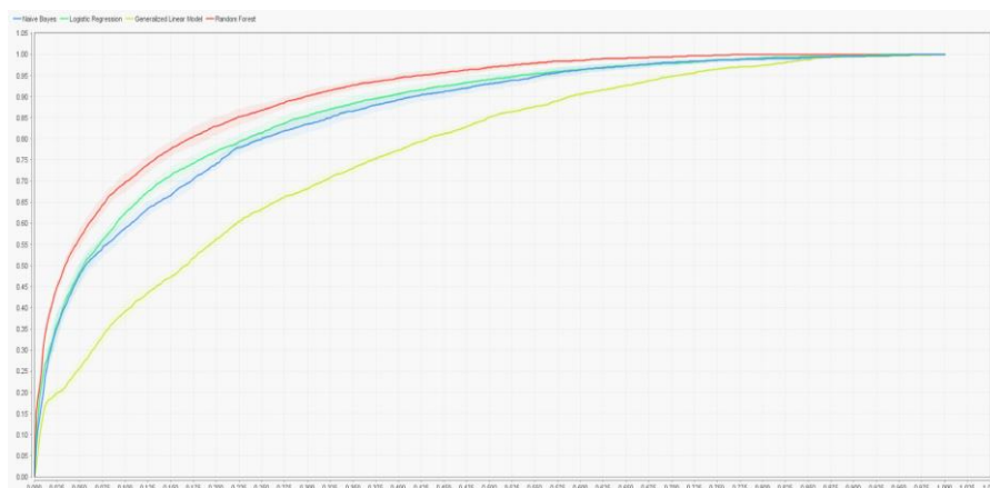
12. ábra: A „Compare ROC” operátor lefuttatásának eredménye (kék: Naive Bayes, zöld: logisztikus regresszió, sárga: általánosított lineáris regresszió, piros: véletlen erdő)
